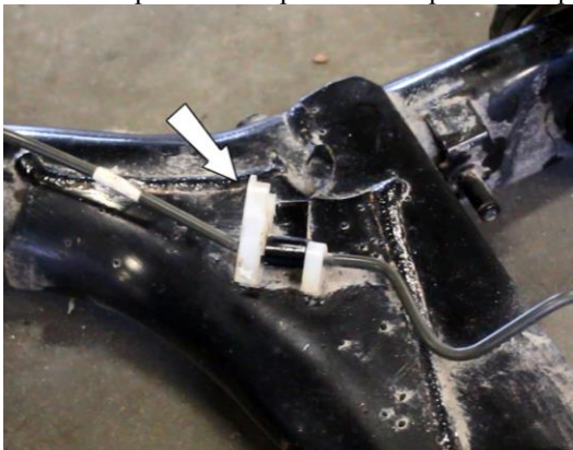
15. Снять кронштейн крепления тормозных трубок
