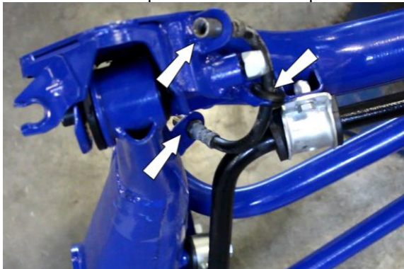
16. Установить тормозные шланги в кронштейны ЗНП
